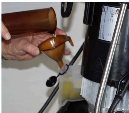
Pumpens oljetank har oljenivåglas och smart töm/fyll-funktion.
