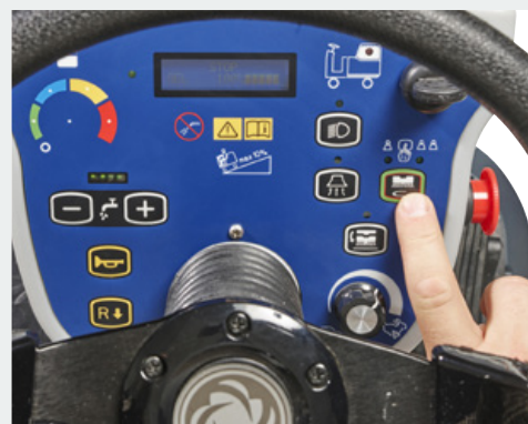
Borsthuvud/sugskrapa sänks automatiskt, vilket avlastar operatören
