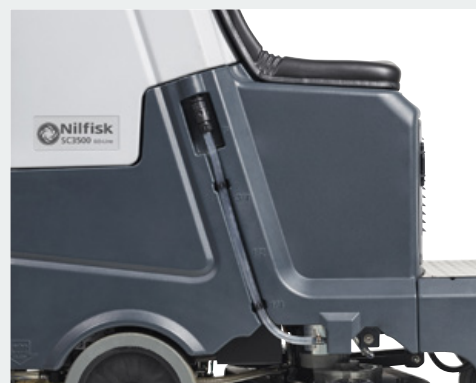
Enkel visuell övervakning av behållarens vattennivå
